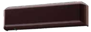
Radar mod. FLEX-T de doble tecnología. detección y cortina de seguridad por infrarrojo activo. La cortina de seguridad pasa al otro lado de la puerta para una mayor seguridad. Conforme a la normativa EN 16005.
